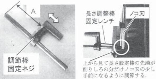
上から見て長さ設定棒の先端が削りしろの分だけノコ刃の少し手前になるように調節する。
