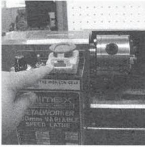
安全スイッチ（緊急停止スイッチ）が働いている状態を確認
