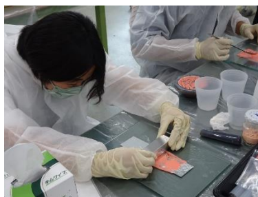
図 6 疑似正極材を用いたリチウムイオン電池製作実習
