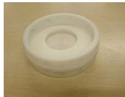
図 3.5.8 GFRP 使用のフィンマウント
