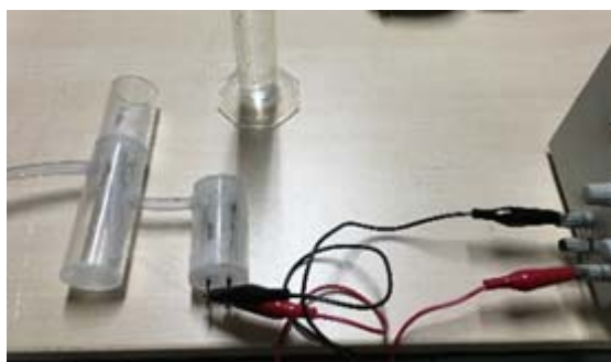
図 3.7.4 製作した水素製造装置の試運転の様子
