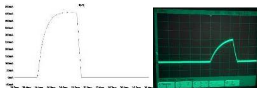
図 3.4.6 改良した回路におけるコイルの電流波形
