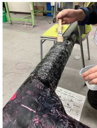
図7 カーボンをクロス接着後の様子
